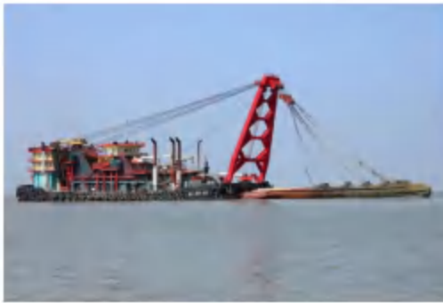
图 3.3.1-4a 射流式采砂船 采砂工艺流程图见图 3.3.1-3。
