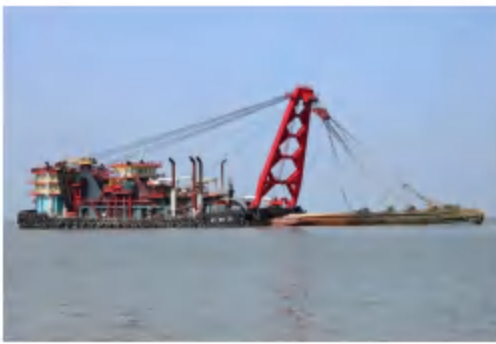
图 3.3.1-4a 射流式采砂船 采砂工艺流程图见图 3.3.1-3。
